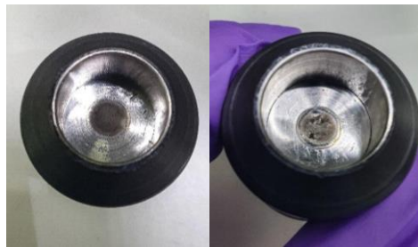
Figura 6. Țintă compactă de ^{64}\text{Ni} vs țintă ce prezintă fisuri
