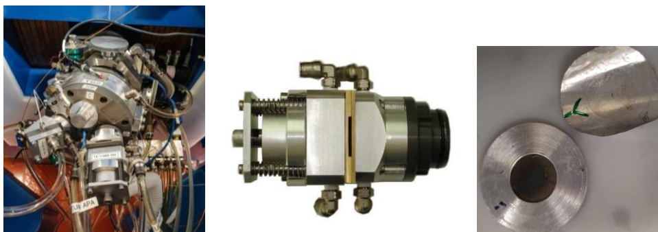
Figura 13. Suportul de ținte solide, ACSI, cu folia de etanșare din Al
